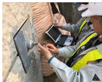
写真3 衝撃弾性波法の状況
