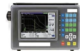
超音波探傷の例 (橋梁点検)
