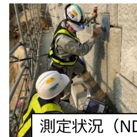
超音波探傷の例 (橋梁点検)
