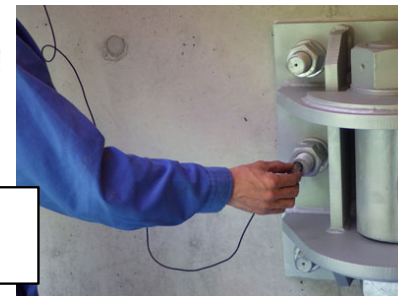
超音波探傷の例 (橋梁点検)
