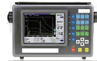
超音波探傷の例 (橋梁点検)
