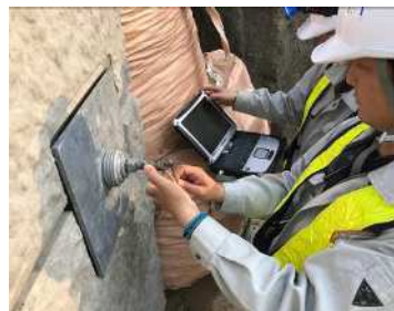
写真3 衝撃弾性波法の状況
