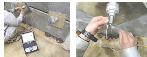
写真2 衝撃弾性波法による測定状況 (左：全景，右：波動の入力)
