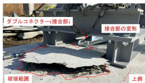
b) 試験終了時 ( \theta = 15^\circ )
