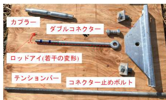
a) 試験終了後の接合部材 ( \theta = 45^\circ )
