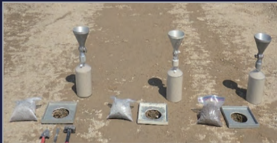
盛土材の状態を確認できるのは500 m 3 に1回のタイミング
