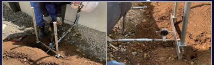
壁背面でトルク値と壁面変位量を計測
