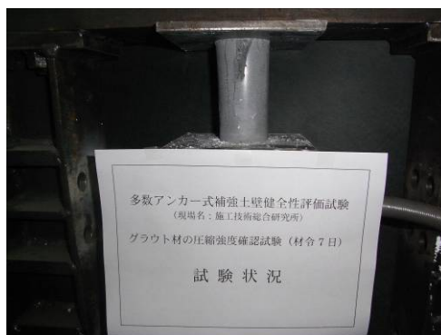
写真 5-4 圧縮強度試験 (例)
